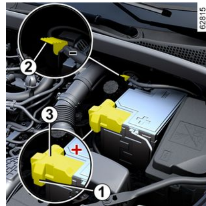
Bateria no compartimento do motor
