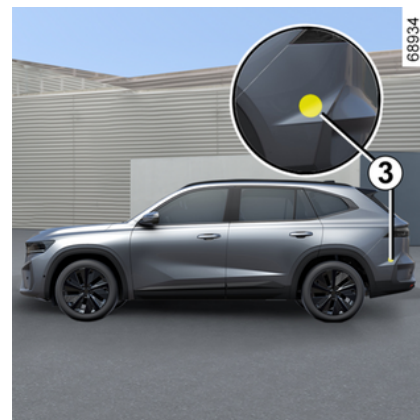
■ Местоположение камеры 1 и радаров 2 и 3
